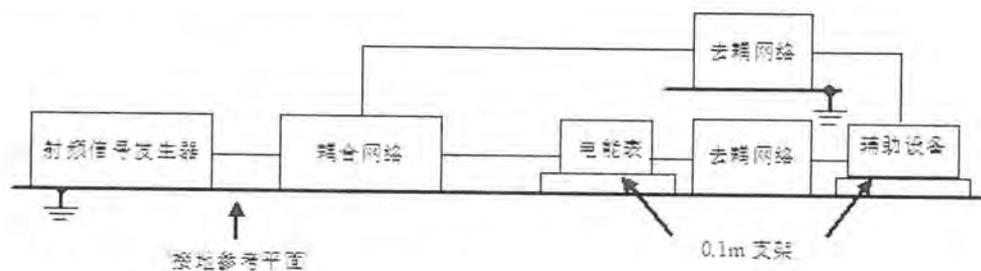
图 4 射频场感应的传导干扰试验布置图
