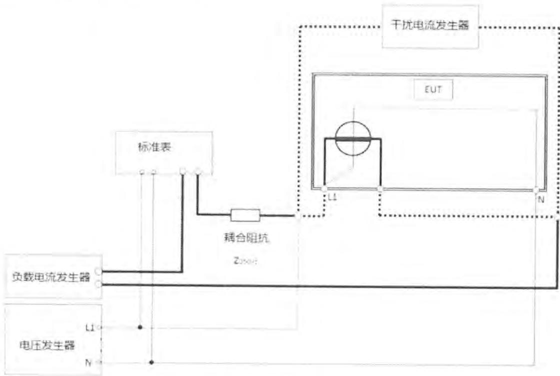
图 18 传导差模电流干扰试验接线图
