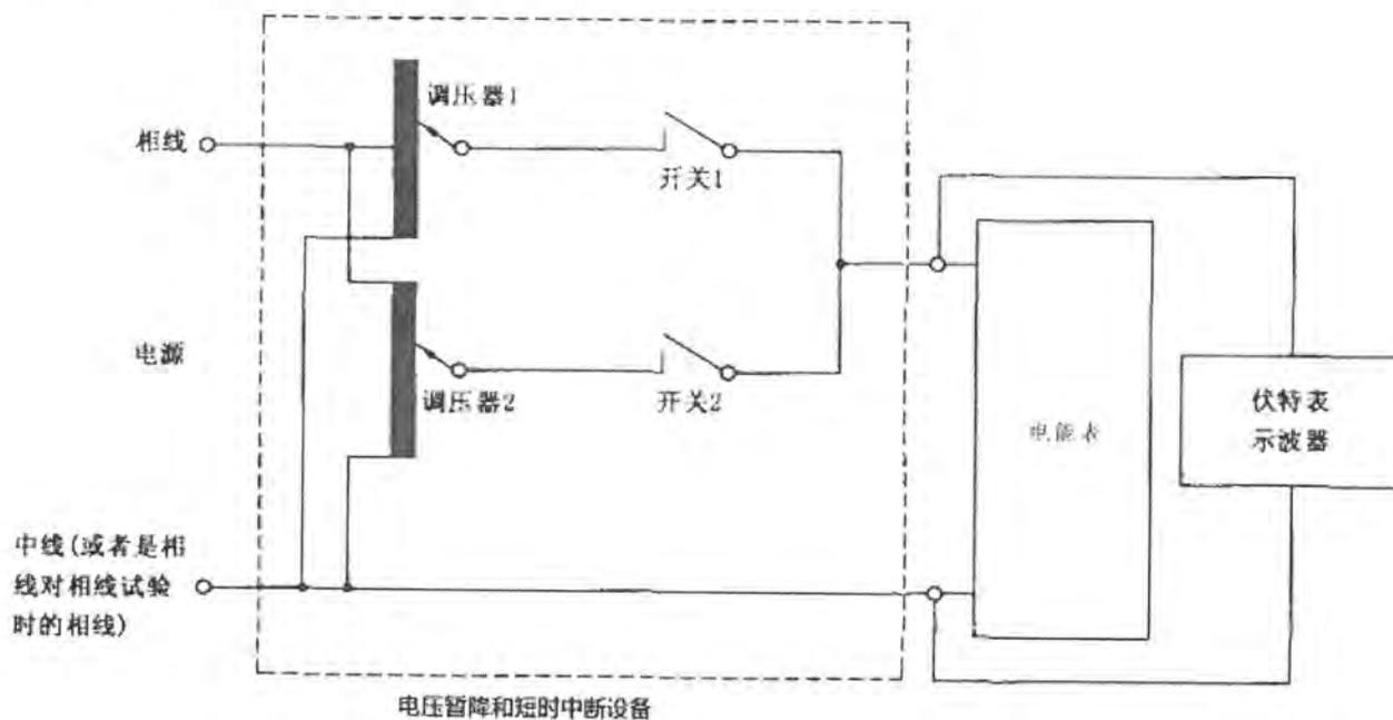
图 2 电压暂降和短时中断试验接线图
