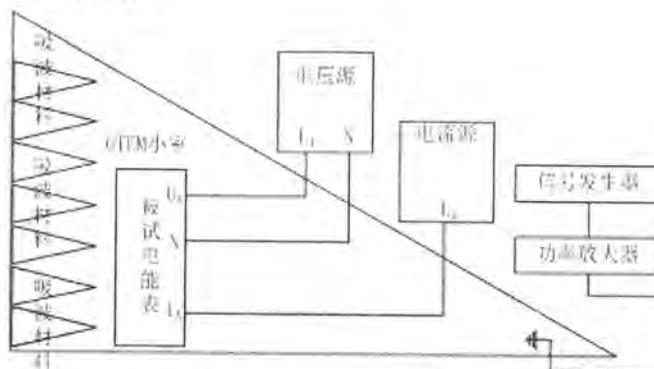
图 7 射频电磁场试验接线布置图
