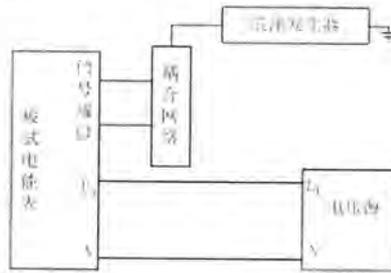
图 13 浪涌试验接线图 (信号端口)
