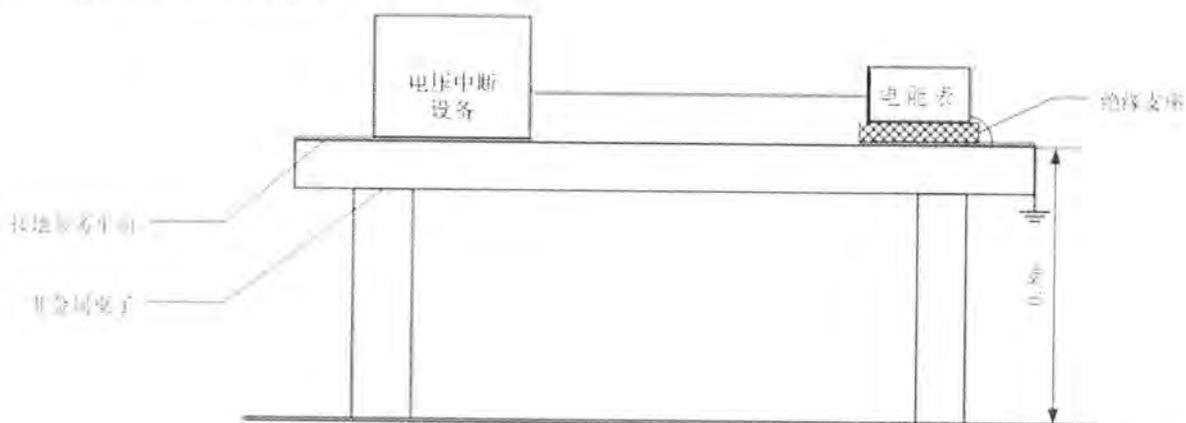
图 1 电压暂降和短时中断试验布置图
