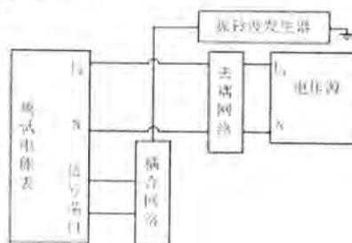
图 17 振铃波试验接线图（信号端口）
