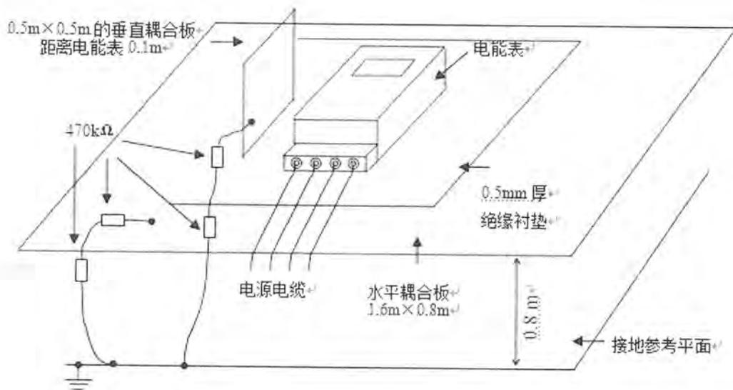
图 6 静电放电试验接线布置图
