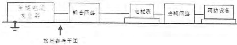
图 14 传导差模电流干扰试验布置图
