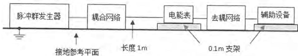
图 8 快速瞬变脉冲群试验布置图
